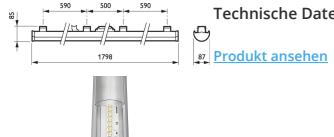
Technische Daten Philips LED Lichtträger Maxos 4MX900 LED90S 840 PSD 1800
