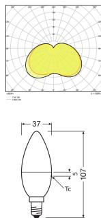
Technische Daten Osram LED E14 Kerze Matt 6W 470lm - 827 Extra Warmweiß | RGBW - Dimmbar - Fernsteuerung - Ersatz Für 40W
