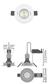
Technische Daten Ledvance LED-Spot Kit schwenkbar GU10 PAR16 8.3W 520lm 36D - 940 Kaltweiß | Höchste Farbwiedergabe - Dimmbar - Ersatz für 65W
