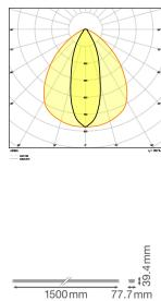
Technische Daten Ledvance LED Tragschiene Trusys Flex Klar Stahl Weiß 35W 6000lm 30D - 840 Kaltweiß | 3 Stunden Notbeleuchtung
