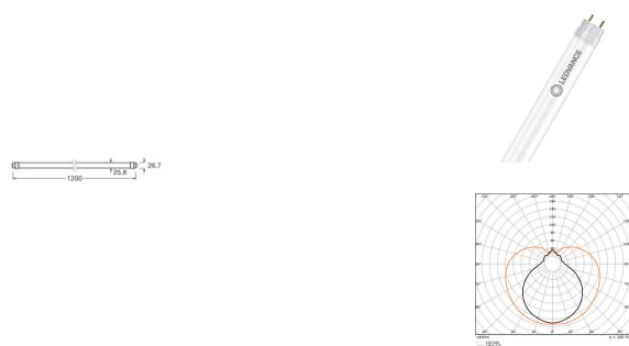
Technische Daten Ledvance LED Röhre T8 EM Value Conventional (EM), Mains (AC) Ultra Output 20W 2160lm - 830 Warmweiß | 120cm - Ersatz Für 36W
