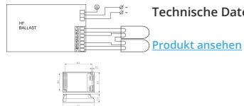
Technische Daten Philips HF-P 2 22-42 PL-T/C/L/TL5C II 220-240V für 2x22-42W
