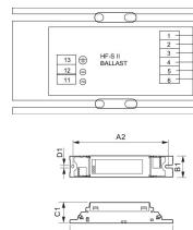
Technische Daten Philips HF-S 258 TL-D II 220-240V 50/60Hz
