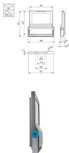
**Technische Daten Philips Led-Scheinwerfer ClearFlood BVP650 Aluminium 47W 7120lm 72x22D - 740 Kaltweiß | IP66 - Symmetrisch**
