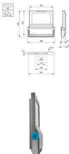
Technische Daten Philips Led-Scheinwerfer ClearFlood BVP650 Aluminium 70W 10680lm 72x22D - 740 Kaltweiß | IP66 - Asymmetrisch
