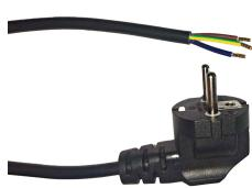
Technische Daten Noxion Power Versorgungskabel Schwarz - Shuko Europlug + Offene Enden - 2m - 3 pole 0,75mm<sup>2</sup>
