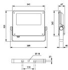
Technische Daten Philips LED-Scheinwerfer BVP125 Coreline 116W 16000lm 40x21D - 740 Kaltweiß | IP66 - Symmetrisch
